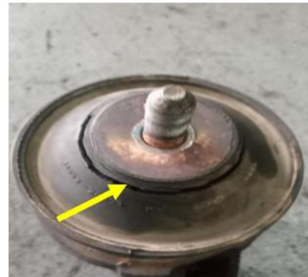
Fig. 3 – Coxim do motor quebrado O que fazer? Substituir
