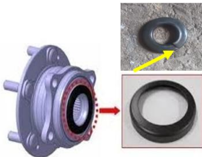
Fig. 1 – arruela do cubo de roda quebrada. O que fazer? Substituir.
