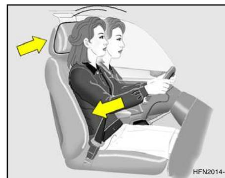
O apoio de cabeça ativo foi projetado para mover-se para frente e para cima no caso de impacto traseiro. Isto evita que a cabeça do motorista ou do passageiro dianteiro se movimente violentamente para trás, reduzindo assim os riscos de lesões no pescoço, muito comuns mesmo em acidentes leves.
