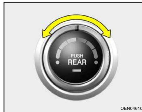
O seletor de controle de temperatura permite regular a temperatura do ar que sai do sistema de ventilação. Para alterar a temperatura do ar no compartimento de passageiros, gire o seletor para a direita para obter ar morno ou quente, ou para a esquerda para obter ar mais frio.
