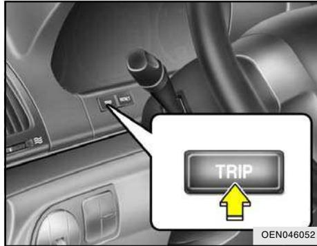
O computador de bordo é um sistema de informações controlado por microcomputador que exibe, no visor de cristal líquido, informações relacionadas à condução, tais como hodômetro, hodômetro parcial, tempo de condução, velocidade média, consumo médio de combustível (se equipado) e autonomia, quando a chave de ignição está na posição "ON". Caso haja desligamento da bateria, todas as informações relacionadas à condução (exceto hodômetro) serão zeradas.
