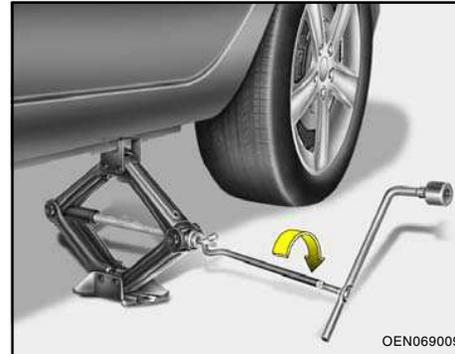
8. Encaixe a haste de acionamento no macaco e gire-a no sentido horário, levantando o veículo até que o pneu desencoste do piso. Essa medida é de aproximadamente 30 mm. Antes de remover as porcas da roda, certifique-se de que o veículo esteja estável e que não possa se movimentar ou escorregar.
