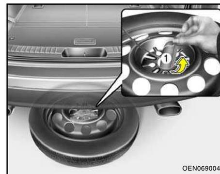
4. Após atingir o piso, continue girando a chave no sentido anti-horário e puxe o pneu sobressalente para fora. Nunca gire a chave excessivamente, ou poderá danificar o suporte do pneu sobressalente.
