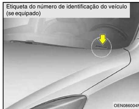
O número VIN também está em uma placa fixada na parte superior do painel de instrumentos.
