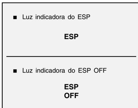
Quando a chave de ignição estiver na posição "ON", a luz indicadora acende e apaga em seguida se o sistema ESP estiver funcionando normalmente.
