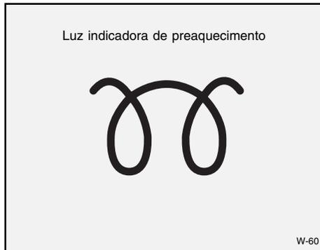
3. Gire a chave de ignição para a posição "ON" para preaquecer o motor. A luz indicadora de preaquecimento acenderá.
