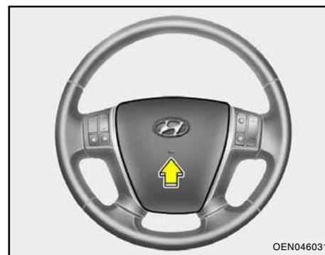
Para acionar a buzina, pressione o símbolo correspondente no volante de direção. Verifique a buzina regularmente, a fim de certificar-se de que ela funciona adequadamente.
