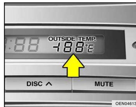
A temperatura externa atual é exibida em incrementos de 1°C (1°F). A faixa de temperatura varia de -30°C a 60°C (-30°F a 140°F).
