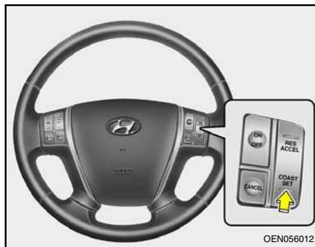
3. Pressione o interruptor “COAST/SET” e libere-o após o veículo ter atingido a velocidade desejada. A luz indicadora “SET” acenderá no painel de instrumentos. Libere o acelerador ao mesmo tempo. A velocidade desejada será mantida automaticamente.
