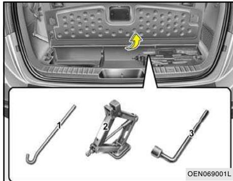
O macaco, a haste de acionamento do macaco e a chave de roda estão guardados no compartimento de bagagem. Levante a tampa do compartimento de bagagem para alcançar esse equipamento.
