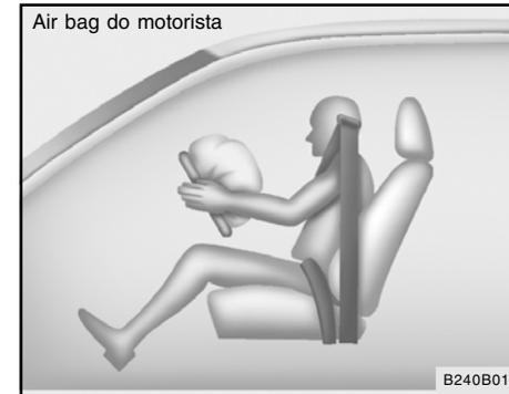
Os módulos de air-bag dianteiros localizam-se no centro do volante de direção e no painel dianteiro do lado do passageiro, acima do porta-luvas. Quando o SRSCM detecta um impacto considerável na dianteira do veículo, aciona automaticamente os air bags.
