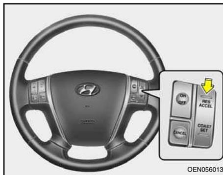
Se algum outro método além do interruptor “ON/OFF” for usado para cancelar o controle automático de velocidade e o sistema ainda estiver acionado, a velocidade programada mais recente irá continuar automaticamente quando o interruptor “RES/ACCEL” for pressionado.
