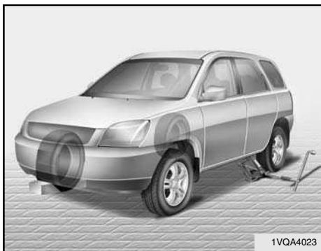
4. Remova a chave de roda, o macaco, a haste de acionamento do macaco e o pneu sobressalente do veículo.
