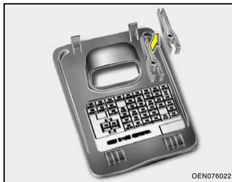
3. Remova o fusível suspeito para fora. Utilize o sacador de fusíveis localizado na tampa do painel.
