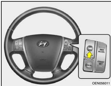
1. Pressione o interruptor de controle “ON/OFF”, localizado no volante de direção para acionar o sistema. A luz indicadora “CRUISE” acenderá no painel de instrumentos.
