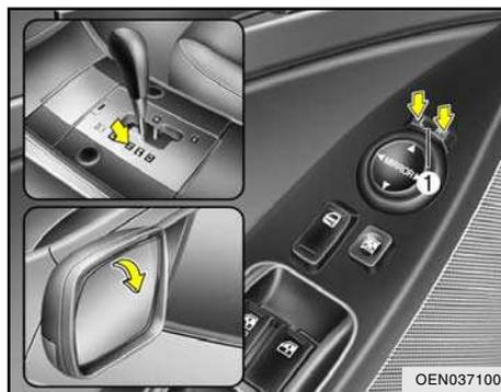
Enquanto o veículo estiver se movimentando para trás, os espelhos retrovisores externos se movimentarão para baixo, a fim de auxiliar o estacionamento em marcha à ré. De acordo com a posição do botão do interruptor, o espelho retrovisor externo funcionará da seguinte maneira:
