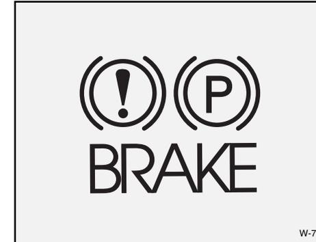
Verifique a luz de advertência do freio girando a chave de ignição para a posição “ON” (sem dar a partida no motor). Essa luz acenderá quando o freio de estacionamento for acionado com a chave de ignição na posição “START” ou “ON”.
