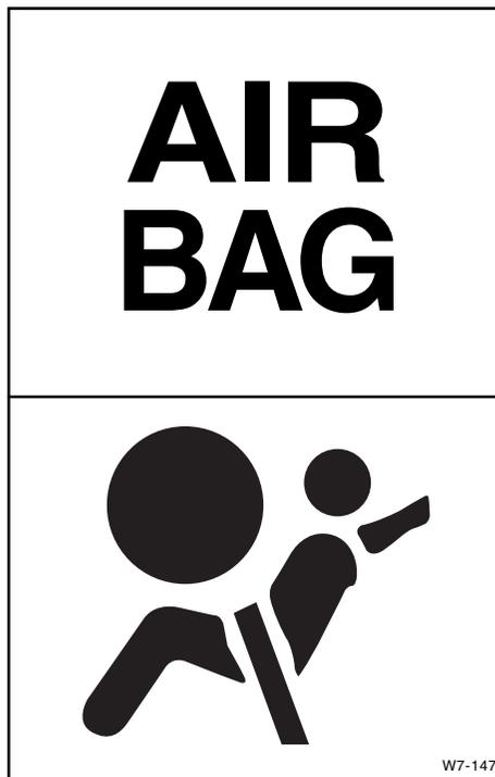
A finalidade da luz de advertência do air bag no painel de instrumentos é alertar o motorista sobre um possível problema com o sistema do air bag (SRS).
