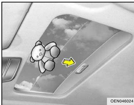
Se um objeto, ou alguma parte do corpo, for detectado durante o fechamento automático do teto solar, ele inverterá o sentido de movimento e a seguir irá parar.
