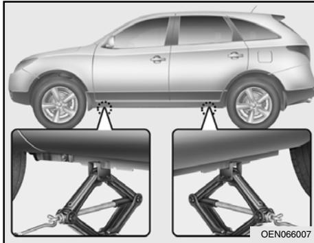
7. Posicione o macaco no ponto de apoio mais próximo (dianteiro ou traseiro) do pneu que irá substituir. Posicione-o nos locais indicados sob a carroceria. Os pontos de apoio do macaco são placas soldadas à carroceria com duas lingüetas e um ponto de levantamento para posicionar o macaco.
