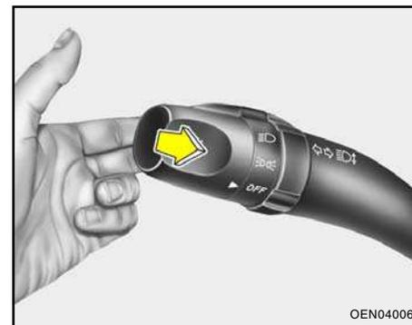
Para lampear os faróis, puxe a alavanca em sua direção. Ao ser liberada, ela voltará à posição normal (farol baixo). Para utilizar o lampejador, o interruptor dos faróis não precisa estar ligado.
