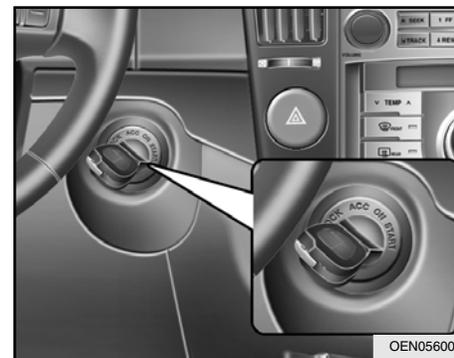
Se a bateria estiver fraca ou a chave inteligente não funcionar corretamente, pode-se dar a partida no motor inserindo a chave inteligente no interruptor de ignição.
