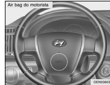
Seu Hyundai é equipado com um Sistema Suplementar de Proteção (Supplemental Restraint System SRS). A indicação da existência do sistema é dada pelas letras “SRS AIR BAG” gravadas em relevo na almofada do volante e no painel frontal no lado do passageiro, acima do porta-luvas. O SRS AIR BAG Hyundai é constituído por air bags instalados debaixo da almofada na parte central do volante e no painel frontal no lado do passageiro acima do porta-
