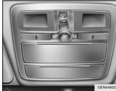
Se o seu veículo estiver equipado com teto solar, este poderá ser deslizado ou inclinado através dos botões de controle localizados no console superior dianteiro. O teto solar somente poderá ser aberto, fechado ou inclinado quando a chave de ignição estiver na posição "ON".
