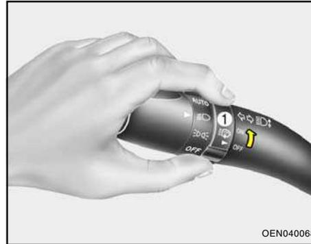
Para acionar o lavador dos faróis, gire o botão para a posição "ON". O lavador será acionado quando o interruptor dos faróis estiver na primeira ou na segunda posição, e a chave de ignição estiver na posição "ON".
