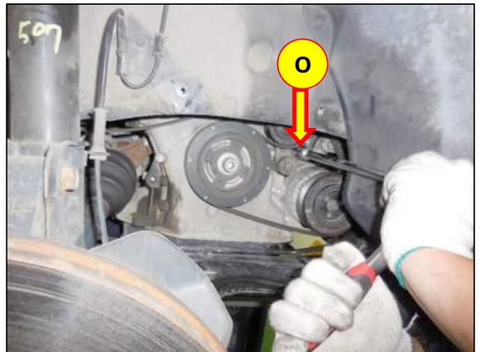
16. Remova o parafuso de montagem inferior do alternador (P).
