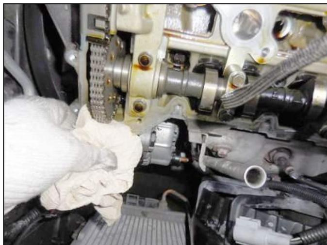
13. Com um desengraxante / limpador (O), limpe qualquer sujeira e óleo remanescentes do cabeçote do cilindro e da tampa e, em seguida, seque com uma toalha limpa que não solte fiapos.
