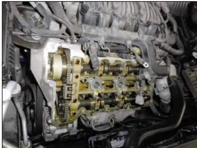
11. Remova todos os resíduos líquidos restantes da junta (incluindo a área externa do cabeçote do cilindro e a tampa da corrente, conforme mostrado na imagem abaixo).
